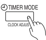
Нажмите кнопку TIMER MODE (РЕЖИМ ТАЙМЕРА) для включения (ON) или выключения (OFF) таймера.
