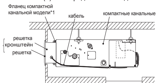
(а) Непосредственное подключение к фланцу
